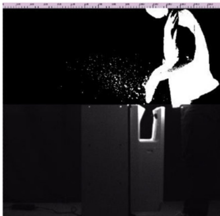
Figuur 6: Verspreiding van druppels boven de handdroger met twee naar elkaar toe gerichte horizontale luchtstromen.
