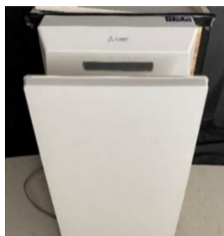
Figuur 2: Elektrische handdroger met twee horizontale luchtstromen.
