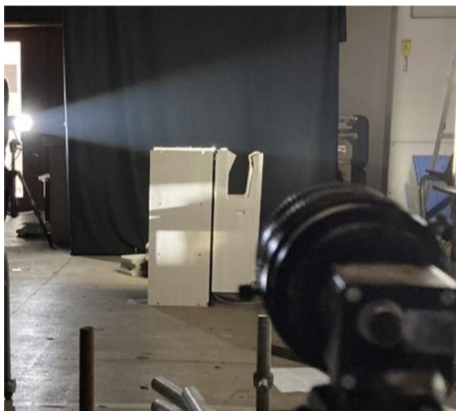
Figuur 4: Meetopstelling om druppels van 1 mm of groter te visualiseren.
