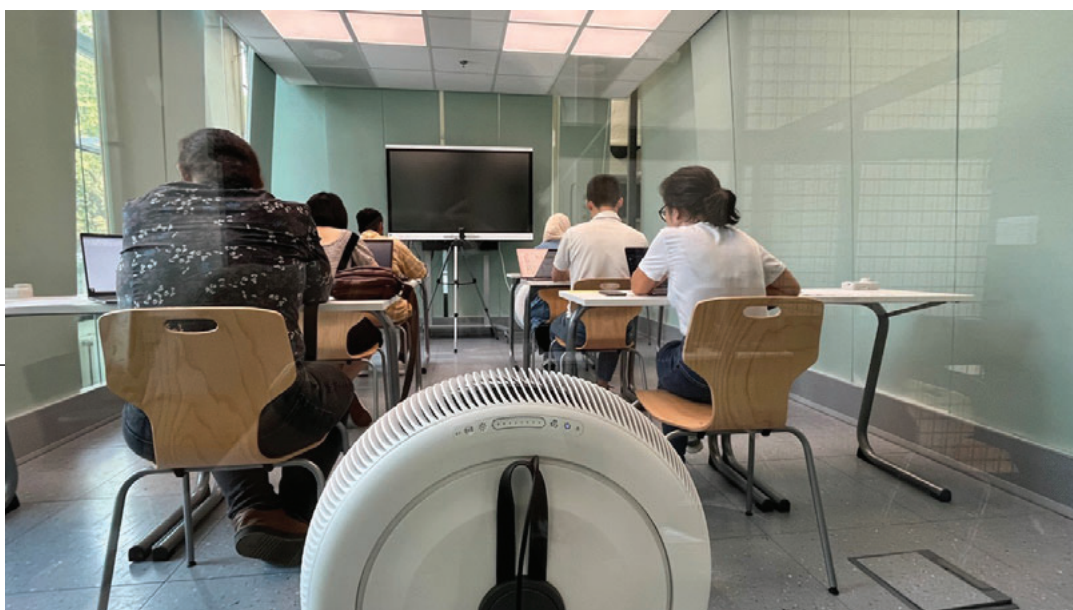
Foto 2: Panel perceptie test t.b.v. het beoordelen van het geluid en tocht geproduceerd door de verschillende mobiele luchtreinigers in de Experience room.
