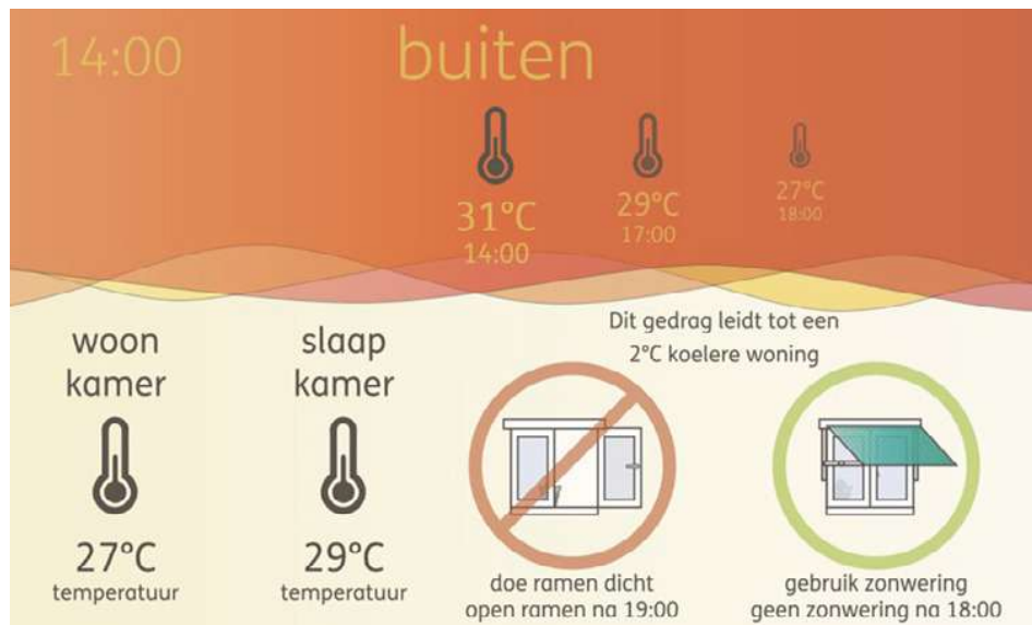
Figuur 2: CoolDownCoach: voorbeeld van een interface die bewoners ondersteunt bij het afwegen van de gevolgen van keuzes. In dit geval het openen van ramen en het bedienen van de zonwering.
