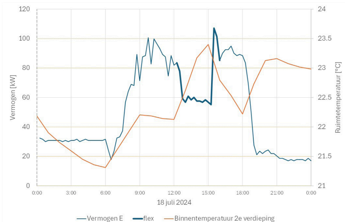
Figuur 1: Afname elektriciteit en binnentemperatuur (kantoren Veolia) bij experiment 1
