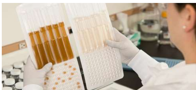
Figuur 7: Testmethode voor alleen pneumophila (bron: Idexx)
