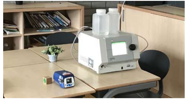
Foto 3: Meting in uitvoering met links de TSI personal aerosol monitor AMS20 en rechts de TSI Condensation Particle Counter 3775.
