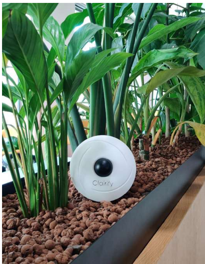
Foto 3: In de Van Nelle Fabriek zijn overal sensoren van Clairify geplaatst, die 24-7 temperatuur, luchtvochtigheid, stofdeeltjes en CO 2 -gehalte meten.
