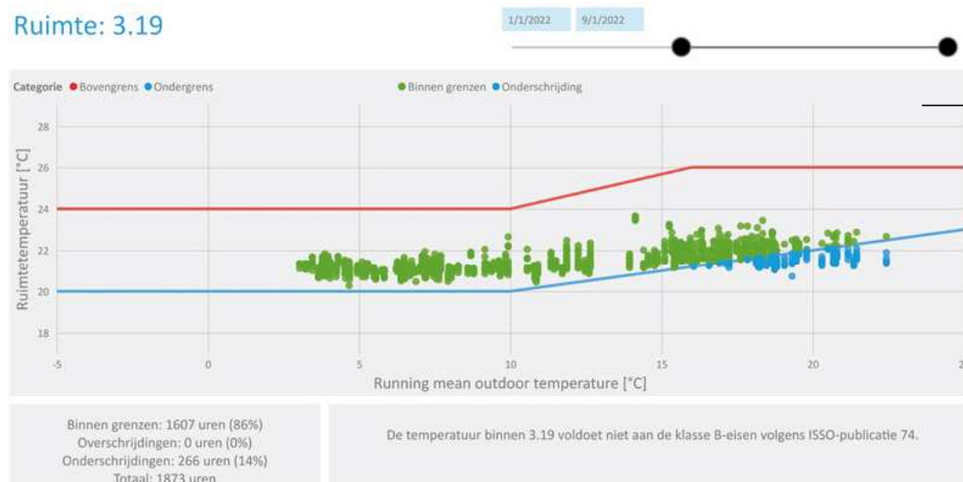
Figuur 2: Voorbeeld van ruimte waar overschrijdingsuren optreden als gevolg van relatief lage basis-setpoints.
