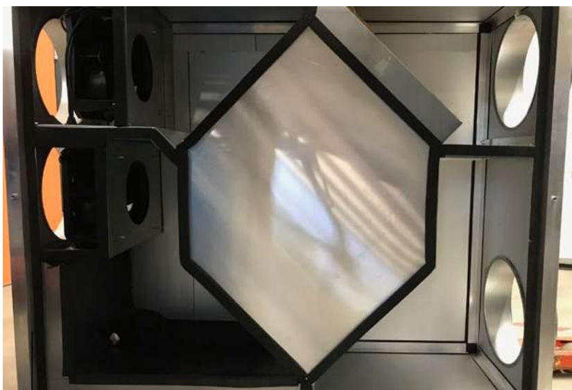
Foto 1: Doorsnede van lab schaal luchtbehandelingskast met indirecte adiabatische koeling. De sproei sectie zit rechts bovenop de aluminium platen warmtewisselaar.
