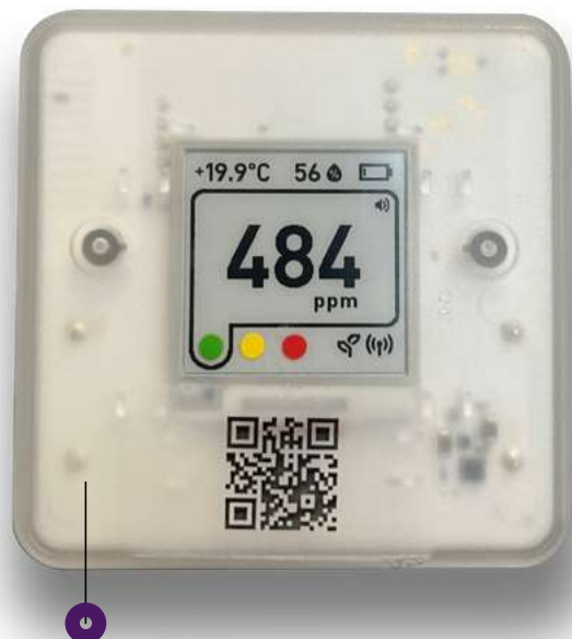
Foto 1: Het SAM Air netwerk, dat in het TVVL-gebouw is geïnstalleerd, bestaat uit relatief eenvoudige sensoren; kleine kastjes die permanent de desbetreffende waarden meten en deze naar onze eigen servers in Nederland versturen.
