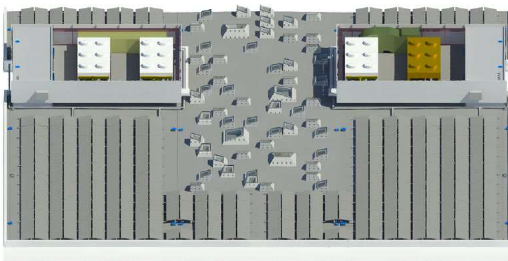
Foto 6: Op het dak staan nog drie extra dry-coolers met een gezamenlijk vermogen van 1500 kW opgesteld, zoals in deze BIM-tekening te zien is. Artist's impressions: Studio 38C.
