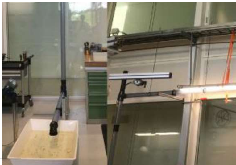
Foto 1: Opstelling binnenriolering bij KWR, inclusief de verticale leiding.
