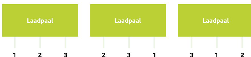
Figuur 4: Fasedraaiing bij laadpalen.
