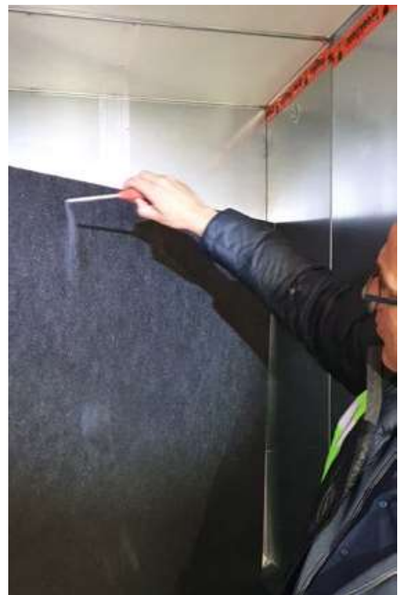
Figuur 11: Luchtstromingsmetingen door middel van rook.
