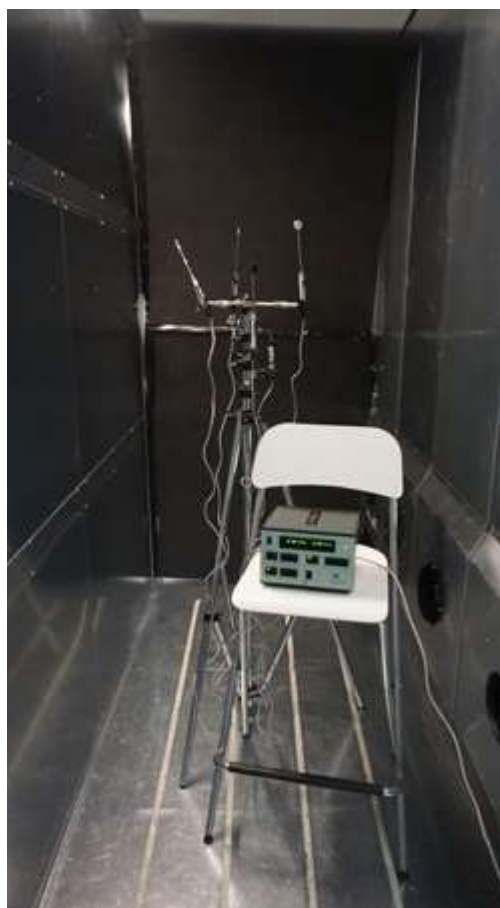
Figuur 12: Links: meetopstelling metingen persistentie aerosolen door UvA. Rechts: meetopstelling metingen thermisch comfort met B&K 1213.
