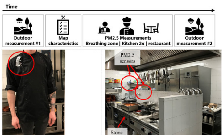
Figuur 6: Schema van het protocol tijdens de metingen [boven]; typische positie van de meetapparatuur [onder].
