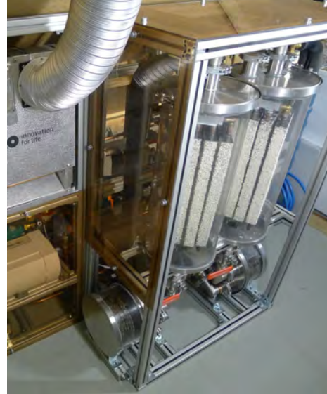
-Figuur 2- proefopstelling van warmteopslag met water en thermochemisch materiaal (TCM). Bij een opgeladen systeem zijn water en TCM gescheiden. Wanneer het water met het TCM in verbinding komt ontstaat een exotherme reactie en komt er warmte vrij voor ruimtes of tapwater. Met warmte van buiten (bijvoorbeeld zon of warmtepomp) vindt een omgekeerde reactie plaats: water en TCM worden gescheiden, de opslag wordt opgeladen.
