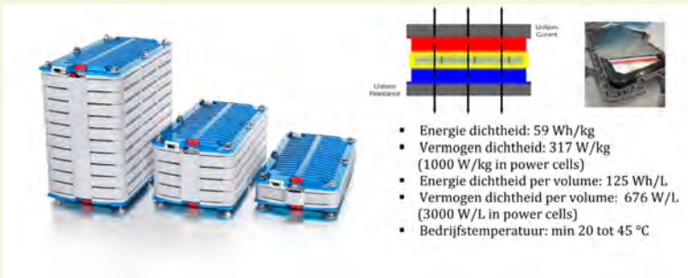
-Figuur 4- Nilar modulaire batterij met uniforme elektronenstroom [3]
