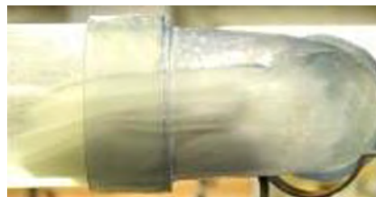
-Figuur 1- Closetpapier wordt in de bocht omhoog gedrukt, spoellichaam D is hier afgebeeld
