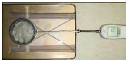
-Figuur 3- Meten van de trekkracht voor het schuiven van toilet papier
