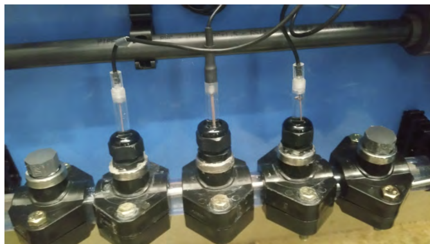
-Foto 6- De Sodi Sensor in bypass tijdens praktijktest in een grote instelling
