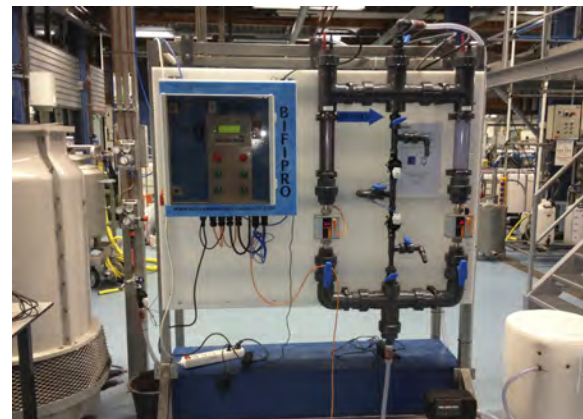
-Foto 2 en 3- Lab-opstelling geplaatst in het WAC. Op de bovenste afbeelding zijn de onderdelen geplaatst op een kunststof plaat met de diverse meetpunten o.a. Silco® Sensor en de terugwinmodule (grijze cilinder links) op basis van grafiet. Op de onderste afbeelding is de koper- en zilverionisatie-apparatuur (Bifipro®) geplaatst. De besturingskast regelt alle andere apparatuur en is via internet toegankelijk.
