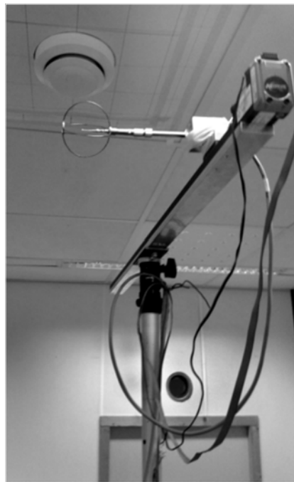
-Figuur 1- Meetopstelling voor het meten van het snelheidsprofiel van een van de onderzochte toevoerventielen (axiaal)
