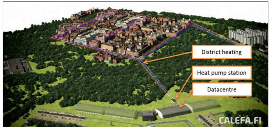
-Figuur 5- het intelligente energienetprincipe van het Yandex datacenter [6]
