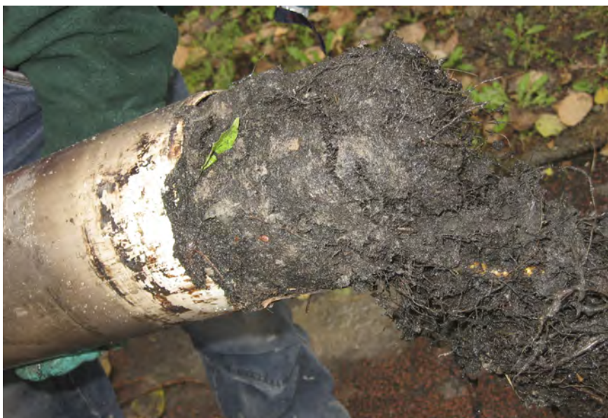
-Figuur 4- Detail van wortelingroei type paardenstaat
