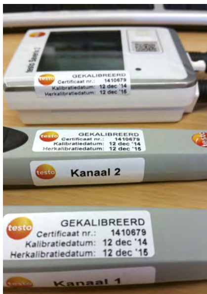
-Foto 1- Datalogger en sensoren zijn samen gekalibreerd
