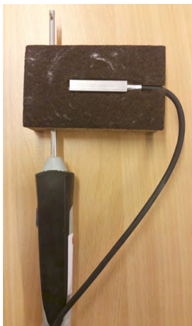
-Foto 2- Houder met meetsensoren voor meting plafondtemperatuur en luchttemperatuur 1 cm onder het plafond
