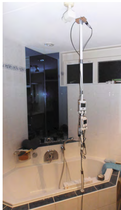
-Foto 3- Plaatsing van de meetboom
