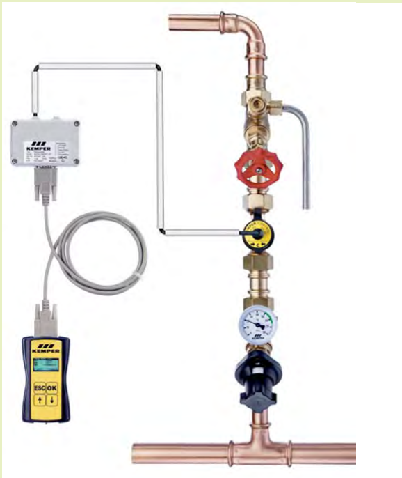
-Figuur 4- Flow- en temperatuursensor Control Plus (Kemper), direct na de monsternamekraan en afsluiter, voor het inregelventiel aan het eind in de circulatieleiding gemonteerd. Met het draagbare handmeetapparaat is een snelle en veilige bewaking van de volumestromen en temperaturen mogelijk. Metingen van drukken en temperaturen aan het buisoppervlak is met het handmeetapparaat eveneens mogelijk. Het Control-plus-systeem is uit te breiden met de sensormeetmodule waarmee opslag en het uitlezen van meetgegevens mogelijk wordt gemaakt.
