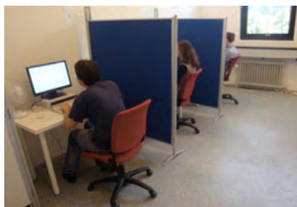
-Figuur 4- Veldlaboratorium zoals gebruikt tijdens het onderzoek aan de Deense Technische Universiteit. Iedere proefpersoon heeft een eigen bureau en een eigen traploos instelbare ventilator.
