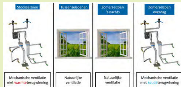
-Figuur 1- Gebalanceerde mechanische ventilatie, gecombineerd met natuurlijke ventilatie (afbeelding Zehnder)
