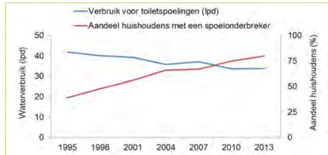
-Figuur 3- Aandeel huishoudens met een toilet met spoelonderbreker en waterverbruik voor toiletspoelingen tussen 1995 en 2013 [5]
