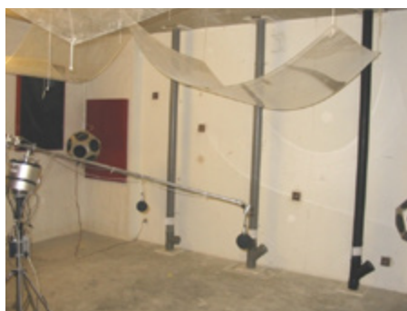
Foto 5: Onderzoek geluidafstraling standleidingen
