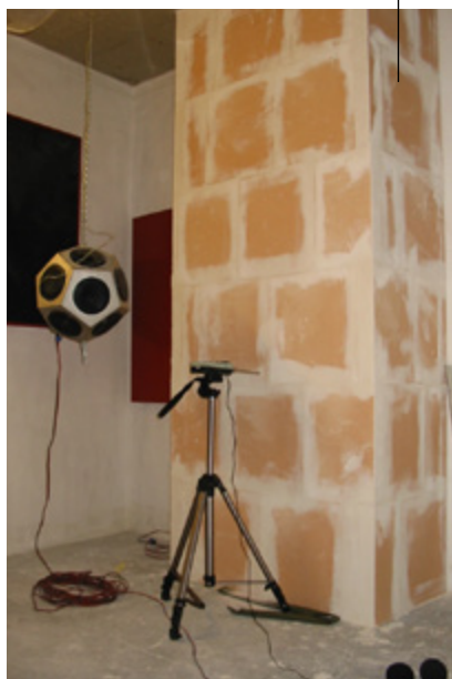
Foto 7 en 8: Onderzoek effect schachtwanden
