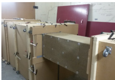
Foto 4: Onderzoek effect uitwendige isolatie luchtkanaal
