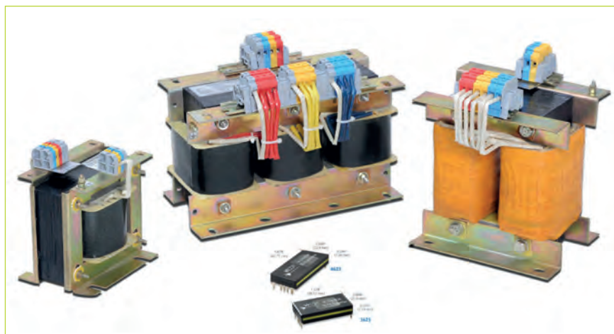
-Figuur 3- Ter vergelijking drie conventionele transformatoren van c.a. 2,5 tot 4 kW, en twee DC-DC converters met een equivalent vermogen en een rendement van 93%. (Victorpower)
