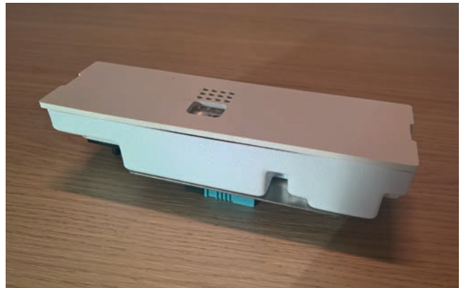
De nodes van bGrid worden op maat gemaakt voor de klimaatplafonds. Ze worden in brackets geklikt vlak naast het verlichtingsarmatuur, waardoor ze nauwelijks opvallen.
