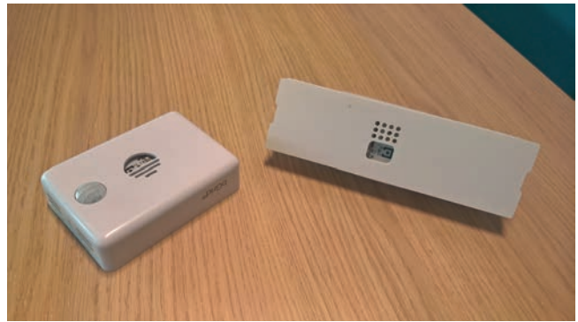
De sensordoosjes komen in verschillende vormen en met verschillende functionaliteiten. Het semitransparante bolletje op de linker node is een PIR-bewegingssensor (passief infrarood).
