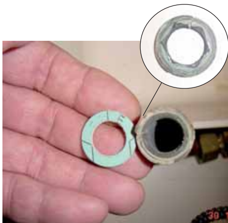
Vergelijking nieuwe- en aangetaste pakkingring.
