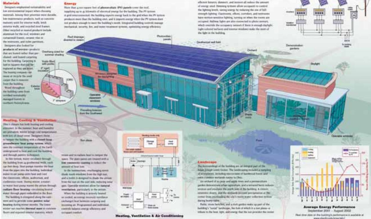
Beknopt overzicht van de energetische maatregelen bij het Oberlin College, bron [6].
