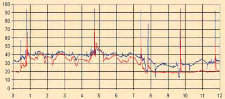
Respons, tijdens twaalf dagen in februari, van een vochtgestuurd ventilatierooster in een badkamer.
