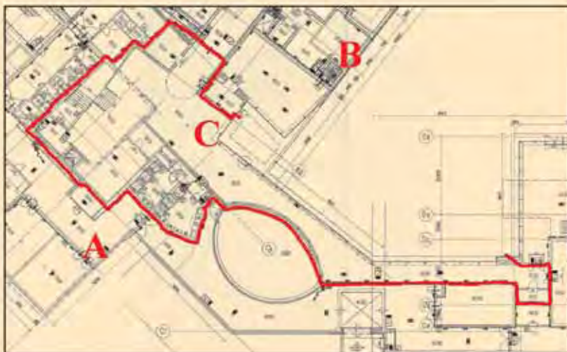
Brandscheiding t.p.v. gang bouwdeel C.
