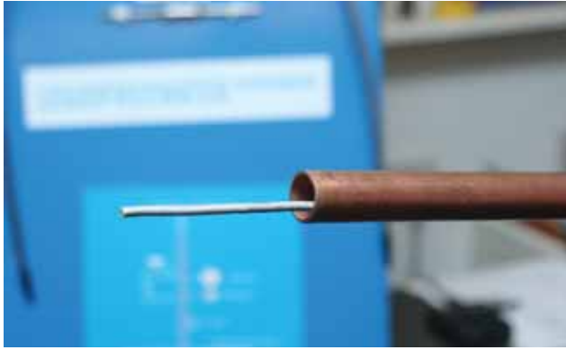
Roestvaststalen lint in koperen pijp.
