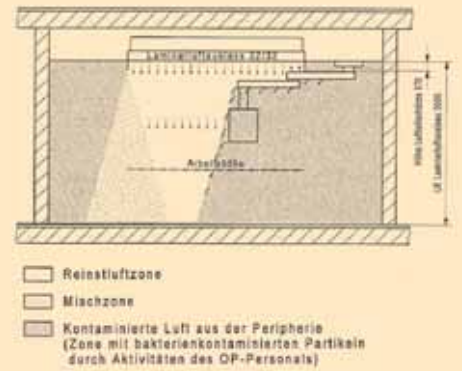
Verstoring van de laminaire luchtstroom door de aanwezigheid van de verzorgingsarm.
