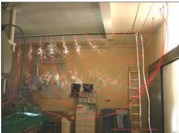
De verticaal ingeblazen lucht buigt vroegtijdig af naar opzij.
