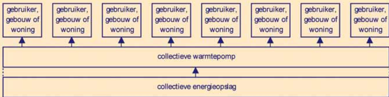
Collectieve energieopslag en collectieve warmtepomp. Bij deze hoofdcategorie wordt zowel de energieopslag als de warmtepomp collectief uitgevoerd. In een centrale, collectieve installatie wordt koude en warmte geproduceerd. De warmte en koude worden vervolgens naar de aangesloten gebruikers, gebouwen en/of woningen gedistribueerd.
