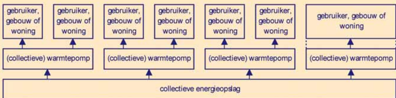
Bij de hoofdcategorie met alleen een collectieve energieopslag worden meerdere warmtepompen aangesloten op de collectieve voorziening. Deze warmtepompen kunnen worden ingezet voor meerdere gebruikers of voor één enkele gebruiker. Beide gevallen zijn in de figuur schematisch weergegeven. In het eerste geval is er toch weer sprake van een collectieve warmtepomp waarbij warmte wordt gedistribueerd naar de achterliggende gebruikers.
