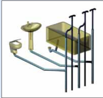
Direct parallel ontspanningssysteem met voor ieder type lozingstoestel een afzonderlijke standleiding.
