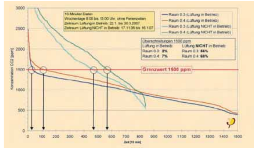
Tien minuten meting van het CO 2 -concentratieverloop in twee bezette klaslokalen in afnemende volgorde, met en zonder het in bedrijf zijn van het ventilatie systeem [12].
