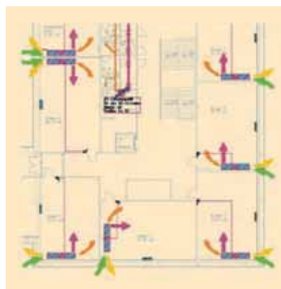
Decentrale ventilatie-units met hoog rendement warmte terugwinning (80-90 %) [20].
