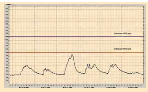
Resultaten CO 2 -metingen na de renovatie [26].
