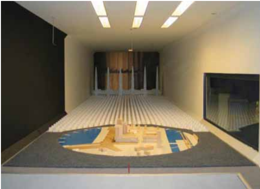
De atmosferische grenslaag windtunnel van Peutz BV te Mook. Zichtbaar zijn de cantelen en ruwheidselementen (het zogenaamde 'voorland') waarmee het snelheidsprofiel wordt opgewekt.
