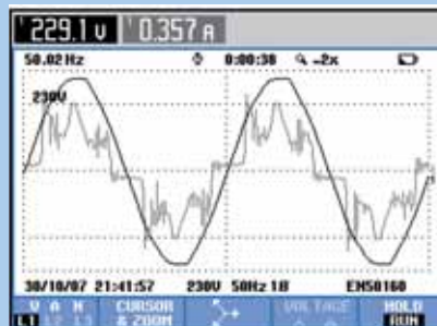
De zéér verstoorde stroomcurve is iets capacitief verschoven t.o.v. de sinus van de spanning.
