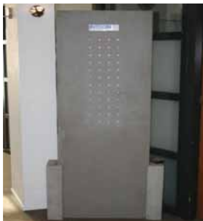
'Levende' betonmuur' LED gecombineerd met fiber optics [8].
