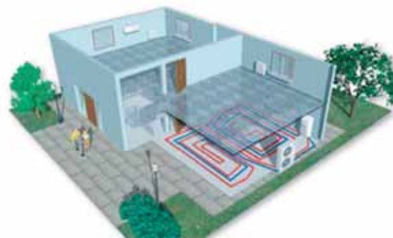
Warmtepomp in combinatie met laagtemperatuur verwarming.
