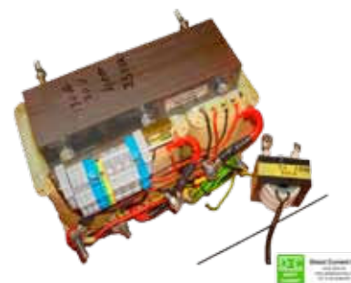
-Figuur 2- Een AC- en DC-transformator van 3kVA
