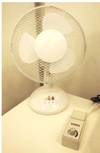
-Figuur 2- Ventilator met traploze controller (rechts onder in beeld); alleen de controller werd gebruikt om de luchtsnelheid in te stellen, de 0-1-2 knop op de ventilator zelf stond altijd in de hoogste stand
