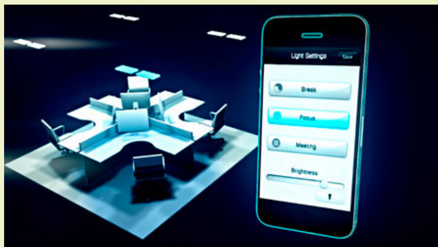
-Figuur 4- Lichtregelsysteem in kantoorgebouw 'The Edge' geeft elke gebruiker controle over zijn eigen werkplek (bron: Philips/Deerns)
