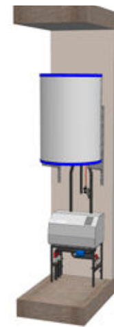
-Figuur 2- Opstelling booster warmtepomp met separaat boilervat
