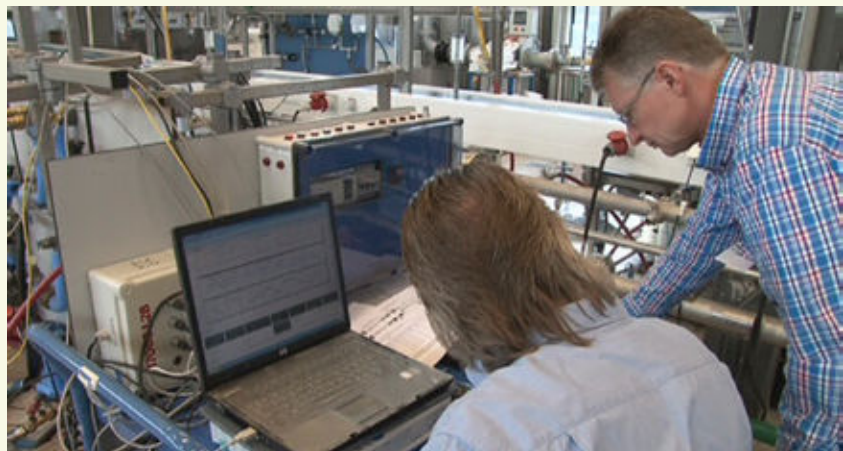
-Foto 2- Onderzoek naar de regelbaarheid van mengkranen in het laboratorium van Kiwa
