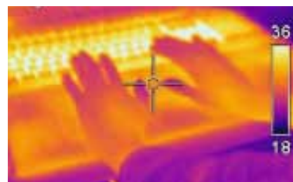
-Figuur 3- Verwarmd keyboard, experimenteel model met uitkomst infraroodmeting (onder) van het Centre for the Built Environment van UC Berkeley [3]
