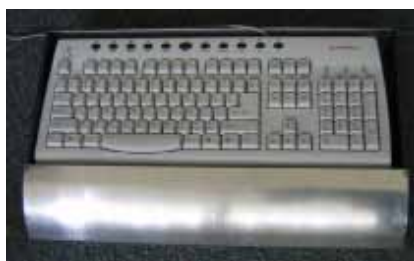
-Figuur 3- Verwarmd keyboard, experimenteel model met uitkomst infraroodmeting (onder) van het Centre for the Built Environment van UC Berkeley [3]
