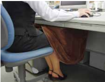
-Figuur 8- Voorbeeld van een commercieel verkrijgbaar Japans product voor lokale verwarming. Het systeem werkt als het traditionele Japanse Kotatsu-systeem en bestaat uit een elektrisch verwarmingselement dat onder de tafel is bevestigd, een deken die de warmte lokaal houdt en een bedieningspaneel op het bureau [7].
