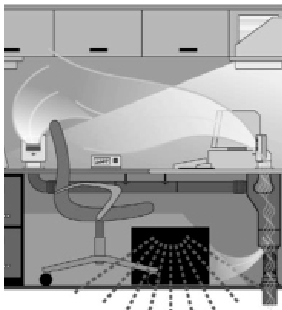
-Figuur 9- Personal Environmental System van Johnson Controls. Dit is een geactualiseerde versie van een systeem dat al eind jaren tachtig van de vorige eeuw op de markt is gebracht. Het systeem is in de basis een persoonlijk ventilatiesysteem met een bedienunit en twee diffusers op het bureau, aangesloten (meestal via de vloer) op een centraal ventilatiesysteem. Het systeem kan eventueel uitgebreid worden met bijvoorbeeld taakverlichting, een individueel bedienbaar geluidmaskerend apparaat en een stralingspaneel voor bijverwarming in de winter [8] [9][10].
