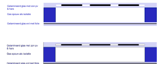
-Figuur 2a- Geïntegreerd glazen dak met pv
